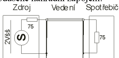
Obr. 5 – náhradní schéma kamerového řetězce
